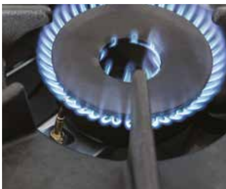
5-kW-GASBRENNER MIT OFFENER FLAMME UND FLAMMENWÄCHTER (SERIENMÄSSIG)
